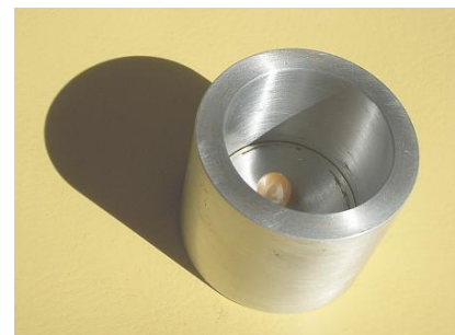
Abbildung 28: Aluzylinder für Schalldruckmessungen
