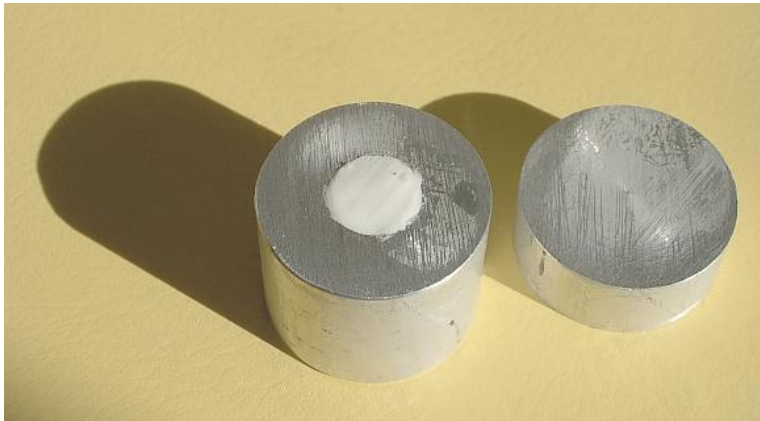
Abbildung 40: Aluzylinder mit Hohlraum für angefeuchtete und gepresste Maisstärke (weiss) mit Deckel (rechts) für künstlichen Pop
