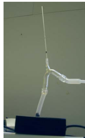
Abbildung 14: Drucksensor mit Druckentlastung über eine Glaskapillare
