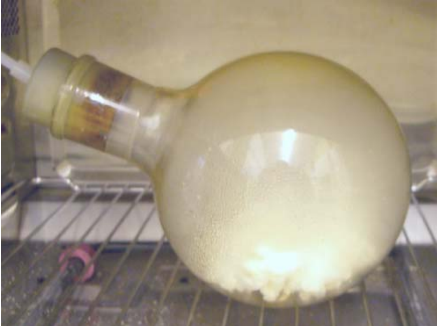
Abbildung 20: Wasserdampf schlägt sich auf der Innenwand des Kolbens im Mikrowellenofen nieder.
